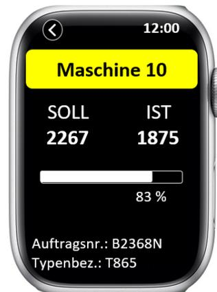
Abbildung 33: Einzelne Maschine - Status Warnung
